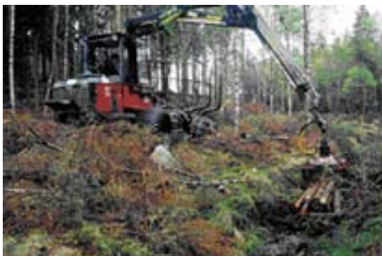
Figur 3. I WWF:s och Sveaskogs demonstrationsprojektet Gallåsen, Västra Götaland, har 2,2 km diken dämms manuellt eller med grävmaskin eller skotare (bilden). Detta resulterade i 5 ha skogliga våtmarker och förbättrad vattenkvalitet nedströms. Foto: Lennart Henrikson, WWF.
