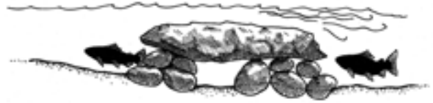
Figur 13. Större sten ska tryckas/grävas ned i botten, men variera alltid. Här är ett förslag (muntligen från Torbjörn Lundberg) hur en flat sten kan användas som ett tak ovanpå två andra stenar. Därigenom kan ett intressant habitat skapas för stor fisk och andra djur.
