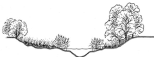
Figur 18. För att ytterligare optimera åplanets funktion och dessutom återskapa ett naturligare vattendrag kan man plantera träd åtminstone på den södra stranden för att ge skugga och lövtillskott.
