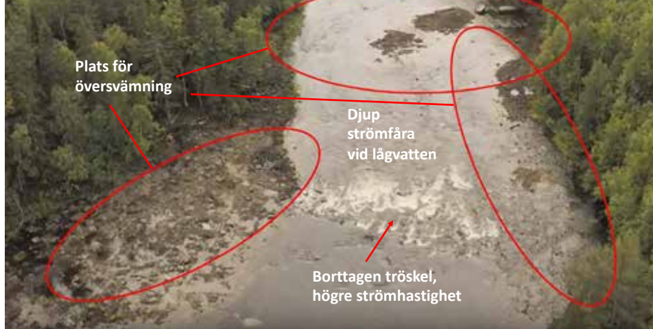
Juktån efter restaurering. Stenkistor och material från flottledsrensningar har återförts till fåran och skapat rum för översvämning där strandvegetation kan etablera sig. Strömvattenfåran är förhållandevis djup för att undvika uppgrundning vid låga flöden, och en tröskel har tagits bort för att öka vattenhastigheten. Drönarfoto: Åsa Widén.
